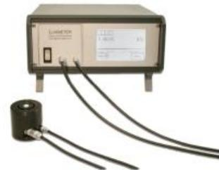
La fotocellula è termostattizzata a  $35^\circ\text{C}$  e viene fornita completa di sostegno da ancorarsi a pavimento o a soffitto.
